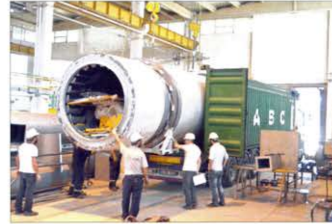
SIGMA Compact tip plentler Konteynerlere sığacak şekilde tasarlanmıştır
